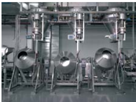
Impianto di ricopertura frutta secca Nuts coating plant
